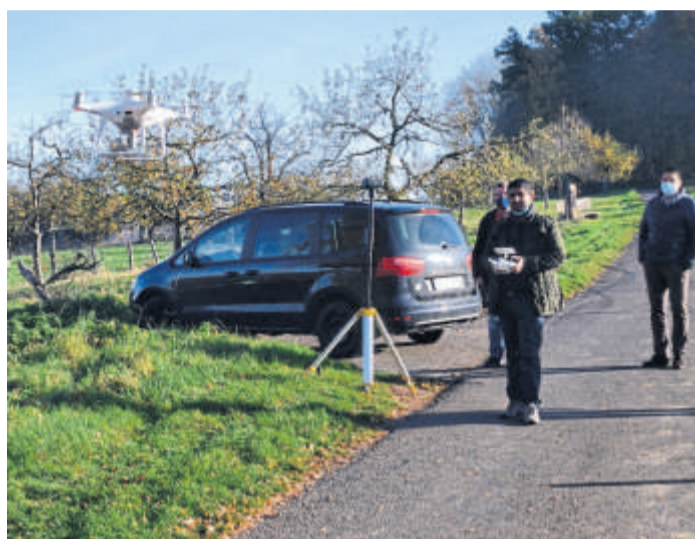
Kartierung von Laubachs Friedhöfen mittels Drohnenbefliegung: Die Fotos zeigen eine Aufnahme aus Ruppertsburg aus 100 Metern Höhe sowie Usman Ahmad beim Steuern des unbemannten Fluggeräts vom Typ »Phantom 4«.
